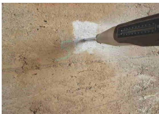
Fot. 4.10 Przykładowe zdjęcia przedstawiające lokalizację punktów badawczych na podporze nr 8 oraz ilustrujące przebieg badania młotkiem Schmidta
