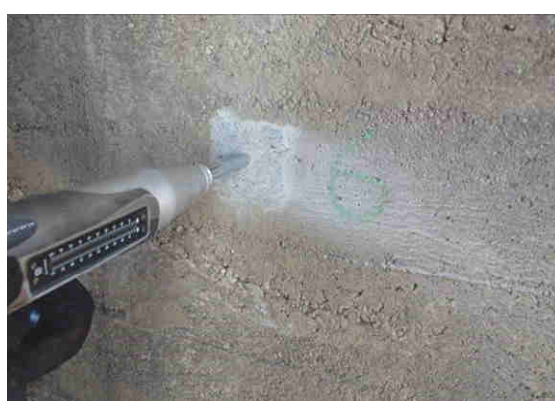
Fot. 4.10 Przykładowe zdjęcia przedstawiające lokalizację punktów badawczych na podporze nr 8 oraz ilustrujące przebieg badania młotkiem Schmidta
