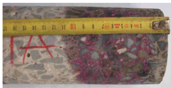
Rdzeń 1 A - głębokość karbonatyzacji: 25 mm
