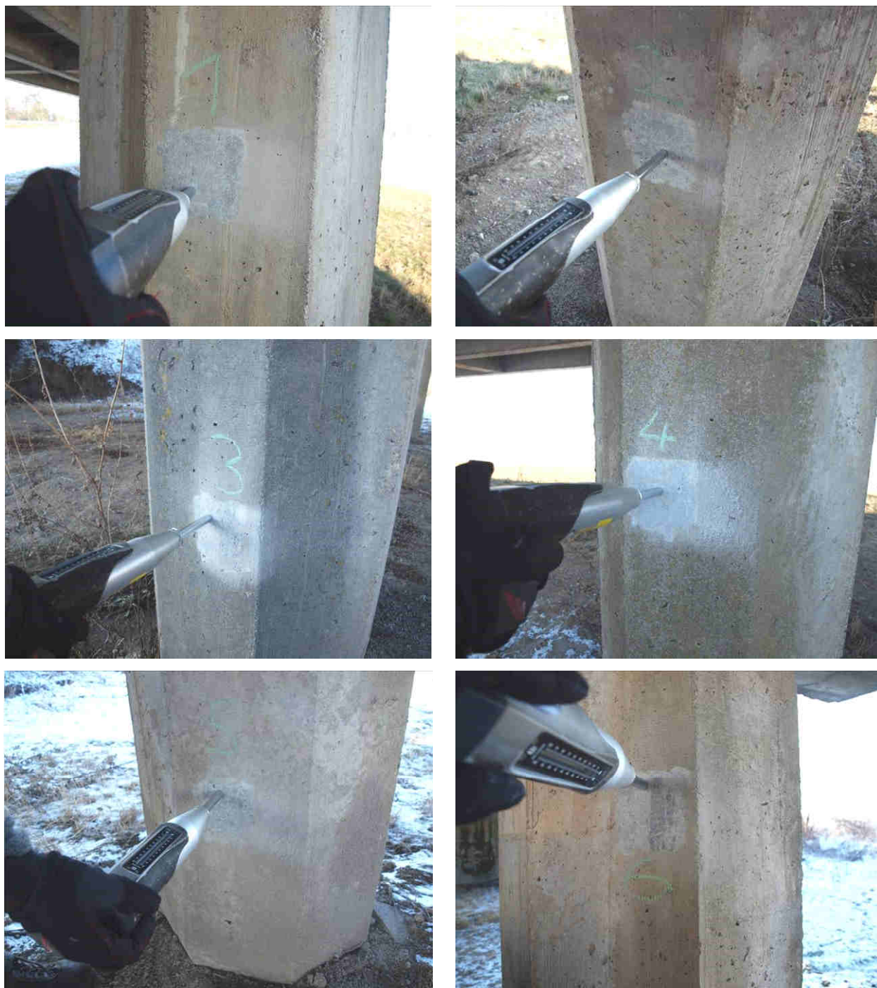
Fot. 4.12 Przykładowe zdjęcia przedstawiające lokalizacje punktów badawczych na słupach podpory nr 2 oraz ilustrujące przebieg badania młotkiem Schmidta
