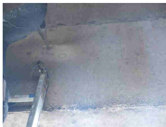
Fot. 4.8 Przykładowe zdjęcia przedstawiające lokalizację punktów badawczych na dźwigarach przęsła nr 2 oraz ilustrujące przebieg badania młotkiem Schmidta
