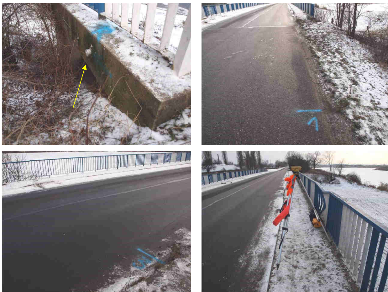
Fot. 4.5 Widok na reper względny, przykładowe przekroje oraz stanowisko niwelatora do przeprowadzenia pomiarów wysokościowych
