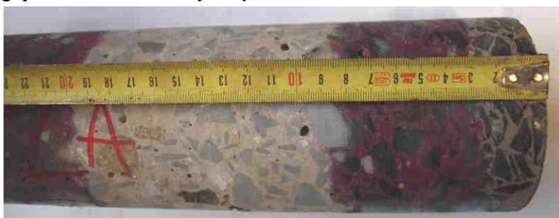
Rdzeń 2 A - głębokość karbonatyzacji: 30 mm
