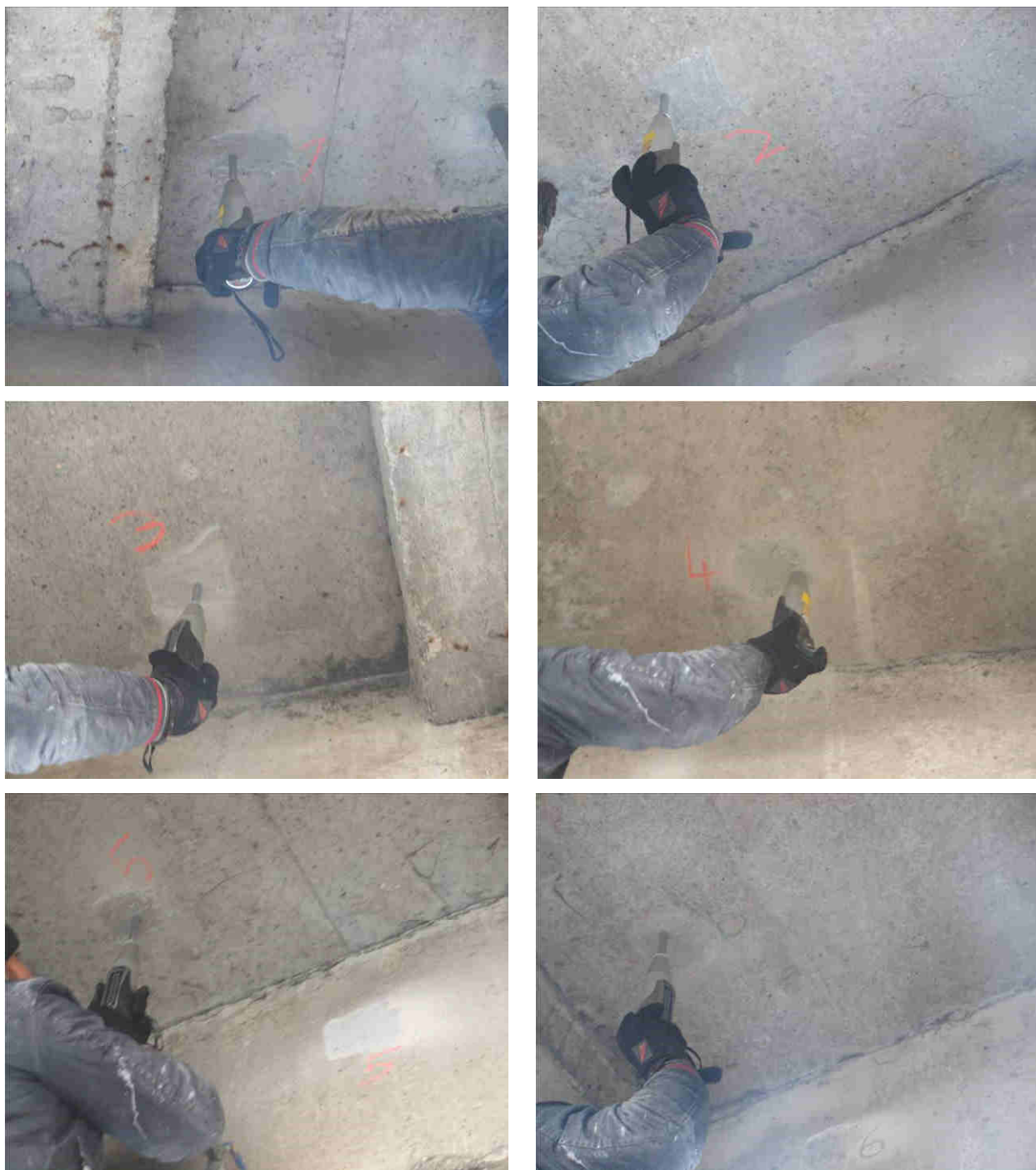
Fot. 4.9 Przykładowe zdjęcia przedstawiające lokalizację punktów badawczych na płycie przęsła nr 2 oraz ilustrujące przebieg badania młotkiem Schmitda
