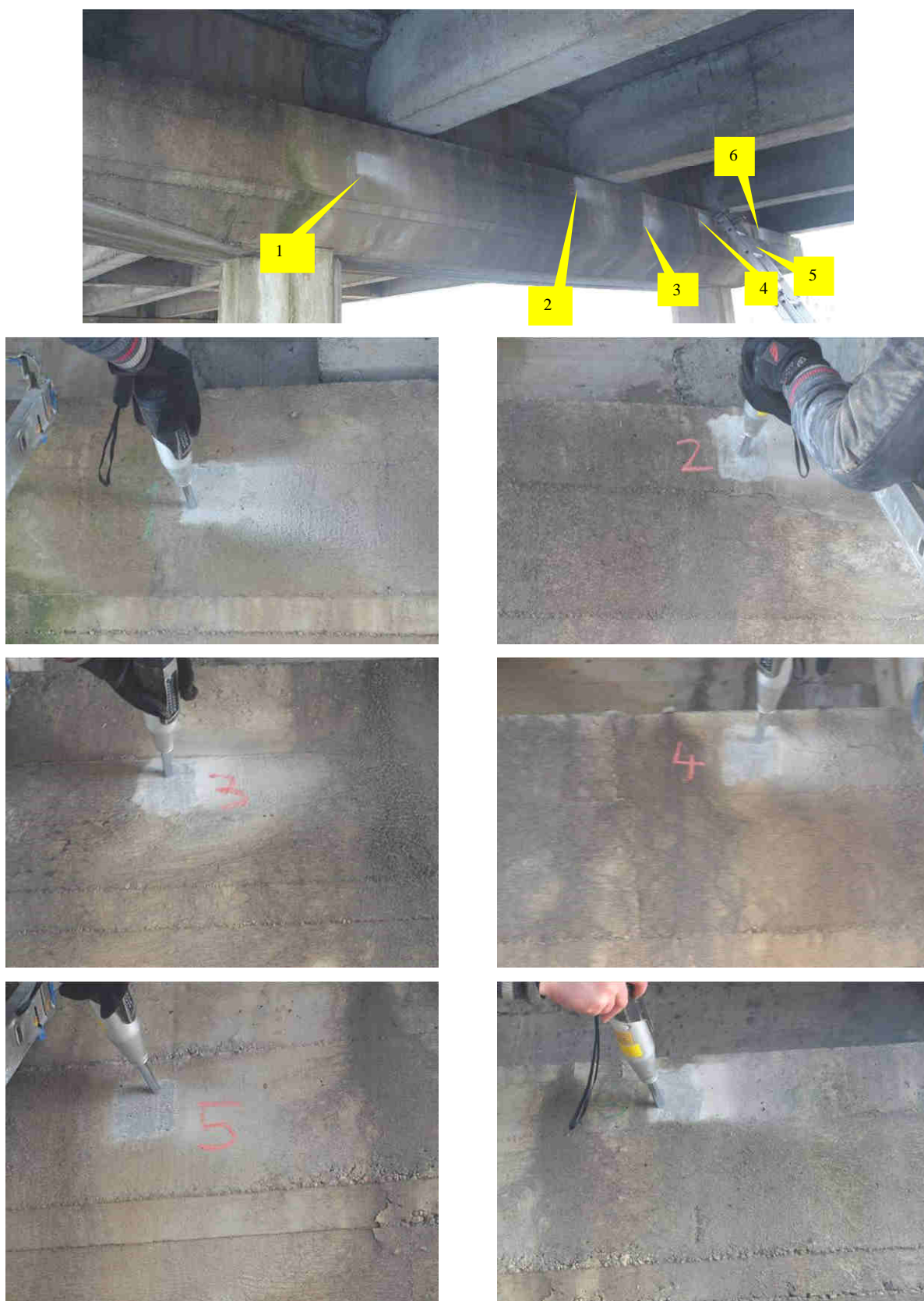
Fot. 4.11 Przykładowe zdjęcia przedstawiające lokalizację punktów badawczych na oczepie podpory nr 2 oraz ilustrujące przebieg badania młotkiem Schmidta
