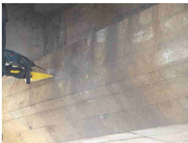
Fot. 4.13 Przykładowy widok na pobór zwiercin do badań chemicznych betonu z dźwigarów, płyty pomostowej oraz oczepu
