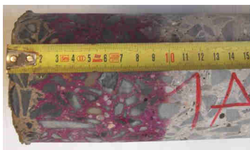
Rdzeń 1 A - głębokość karbonatyzacji: 25 mm
