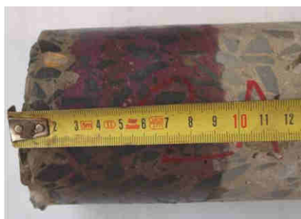
Rdzeń 2 A - głębokość karbonatyzacji: 30 mm
