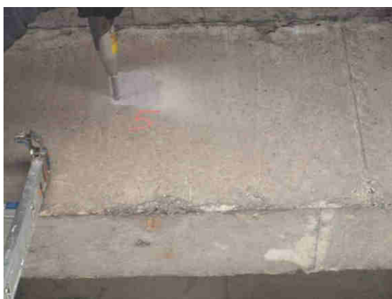
Fot. 4.8 Przykładowe zdjęcia przedstawiające lokalizację punktów badawczych na dźwigarach przęsła nr 2 oraz ilustrujące przebieg badania młotkiem Schmidta
